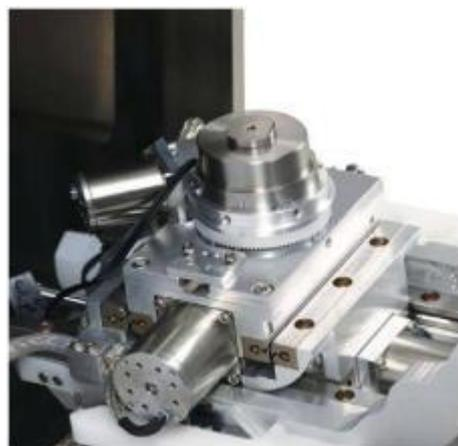
Съемный детектор «на просвет» монтируется на столик образцов сканирующего электронного микроскопа TESCAN
