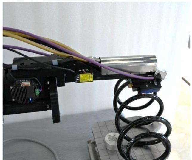
Патентованная металлокерамическая рентгеновская трубка собственного изготовления характеризуется длительным сроком службы и простотой замены. Изготавливаются аноды из следующих материалов: Cr, Mn, Cu, Co, Fe, V и т.д.
