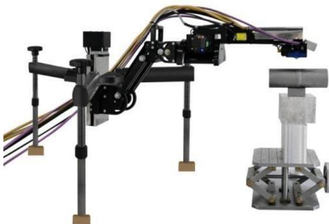
Предназначен для определения остаточного аустенита в стальных деталях, а также для измерения остаточных напряжений в изделиях из кристаллических материалов (металлов, керамики и т.д.). Анализатор применяется полевых условиях, лабораториях и цехах, для контроля эксплуатационных характеристик изделий.
