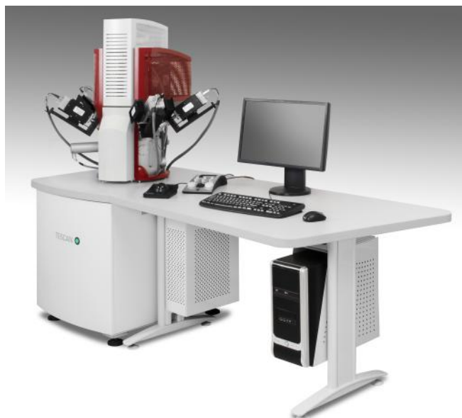
Рис. 1: В данной работе использовался сканирующий электронный микроскоп TESCAN Mira 3 LMU
