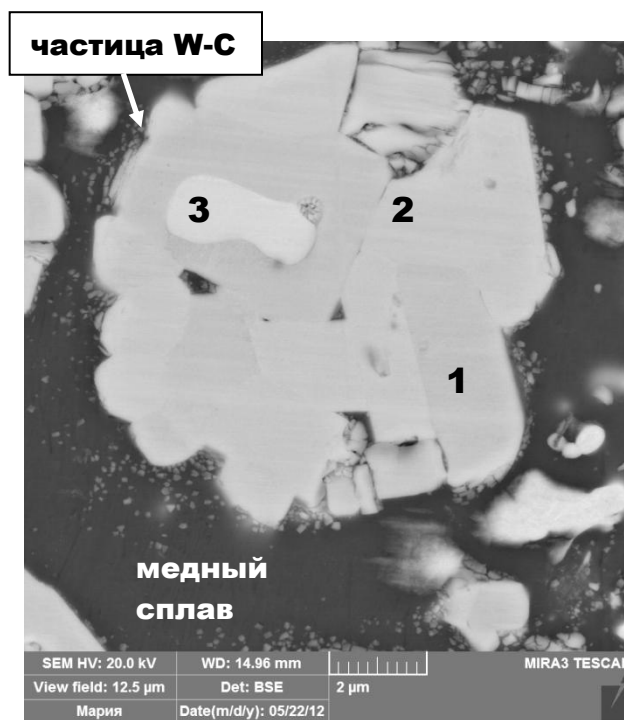
Рис. 2: Шлиф медного сплава, содержащего частицы карбида вольфрама. Общий вид (а) и одна из частиц W-C (б)
